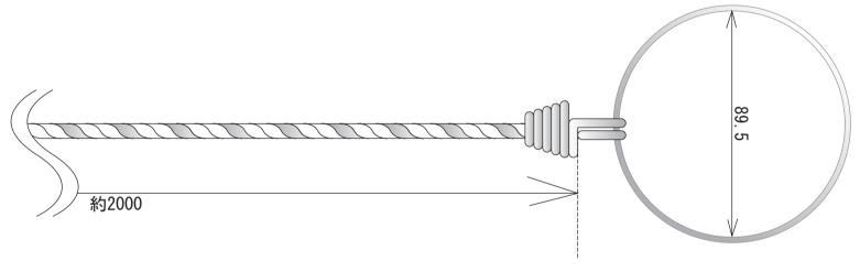
●ロープ径:約10.5mm ●金具線径: 2.2mm
