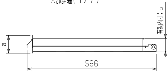
飛び出し防止機構A部詳細 (S=1/5) ※引き手キャップを外した状態 A部詳細 (1/7)
