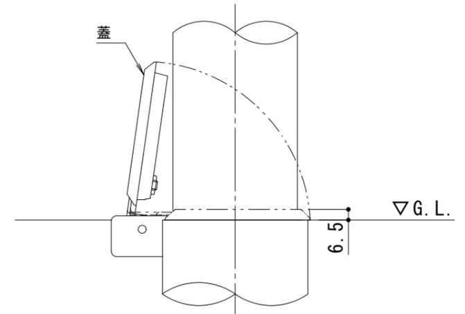
埋設管蓋部詳細図 S = 1 : 3
