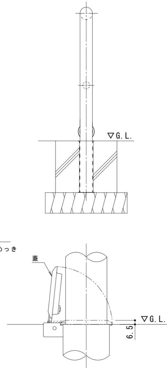
埋設管蓋部詳細図 S = 1 : 3
