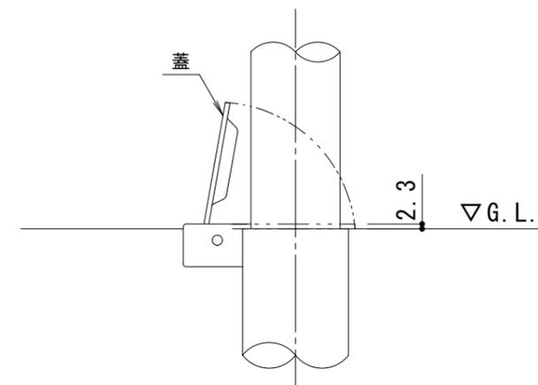
埋設管蓋部詳細図 S = 1 : 3
