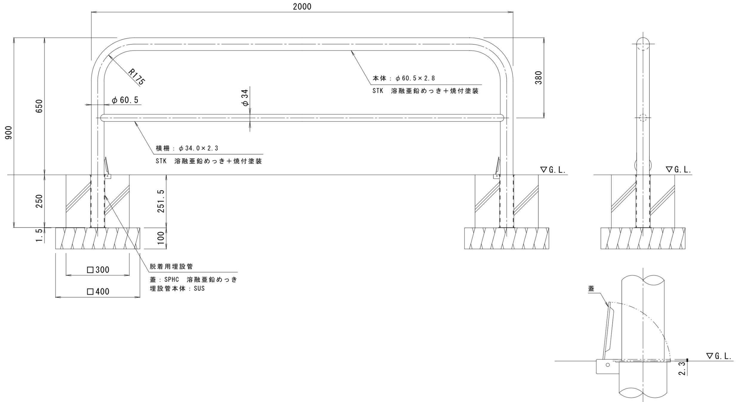
埋設管蓋部詳細図 S = 1 : 3
